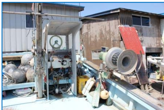
前部甲板右舷側に設置された操舵場所と揚網用ローラー
