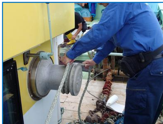
左手がキャプスタンのドラムとロープの間に挟まれた状況 (現場調査時に再現)
