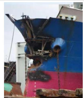
B船の損傷状況
