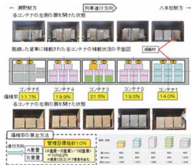
12両目貨車の積荷の状況
