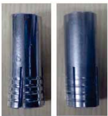
左：コーン挿入後に取外した状態 右：コーン挿入前の状態
