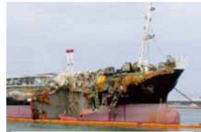
油タンカー宝運丸 橋梁衝突
