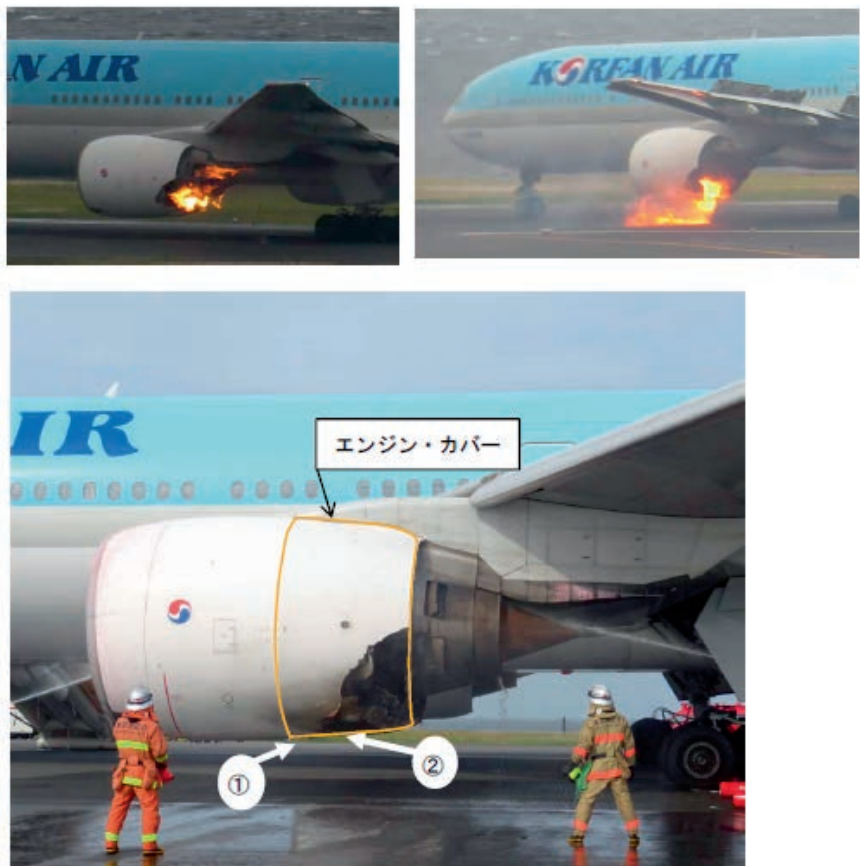
第1エンジンの火災の状況
