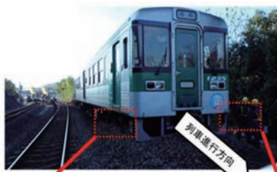
車止めの砂利盛りに進入して停止した列車
