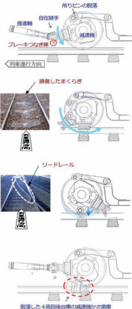
脱線の経過（推定）
