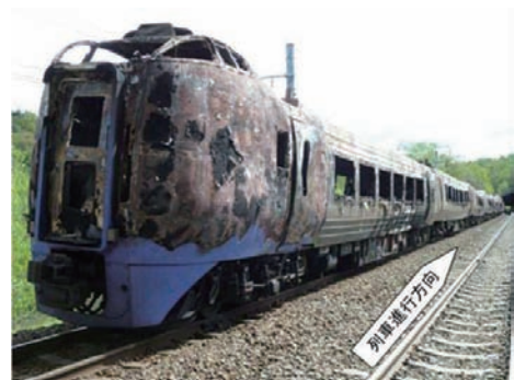
車両の焼損状況
