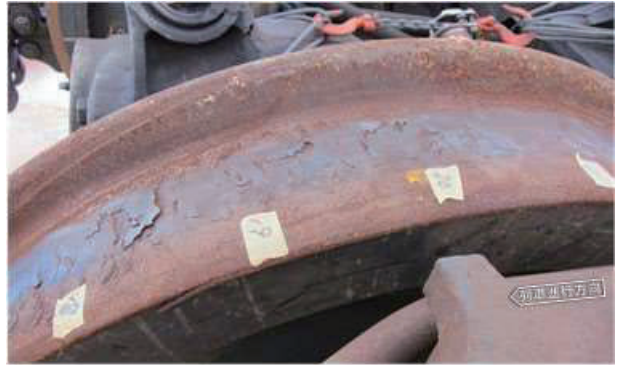
車輪の踏面剥離の状況
