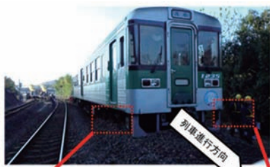
車止めの砂利盛りに進入して停止した列車
