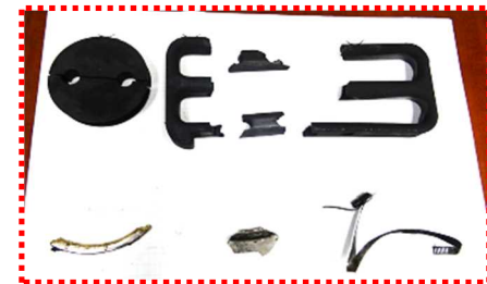
図8 滑走路から回収した部品
