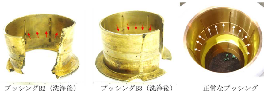
図15 ブッシング内径面のグリースの通路（溝）
