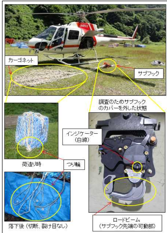
写真 同機（サブフックにカーゴネットを接続）
