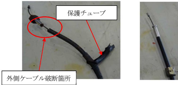
写真6 破断した同機のケーブル（左）及び正常なケーブル（右）
