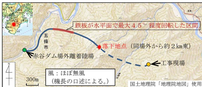
図2 推定飛行経路及び落下地点
