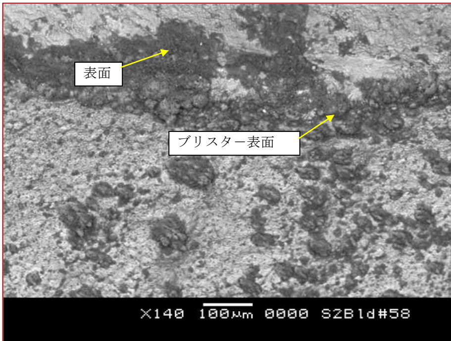
写真 2 2 58番ブレードの破断起点域表面及び ブリストア表面の成分分析
