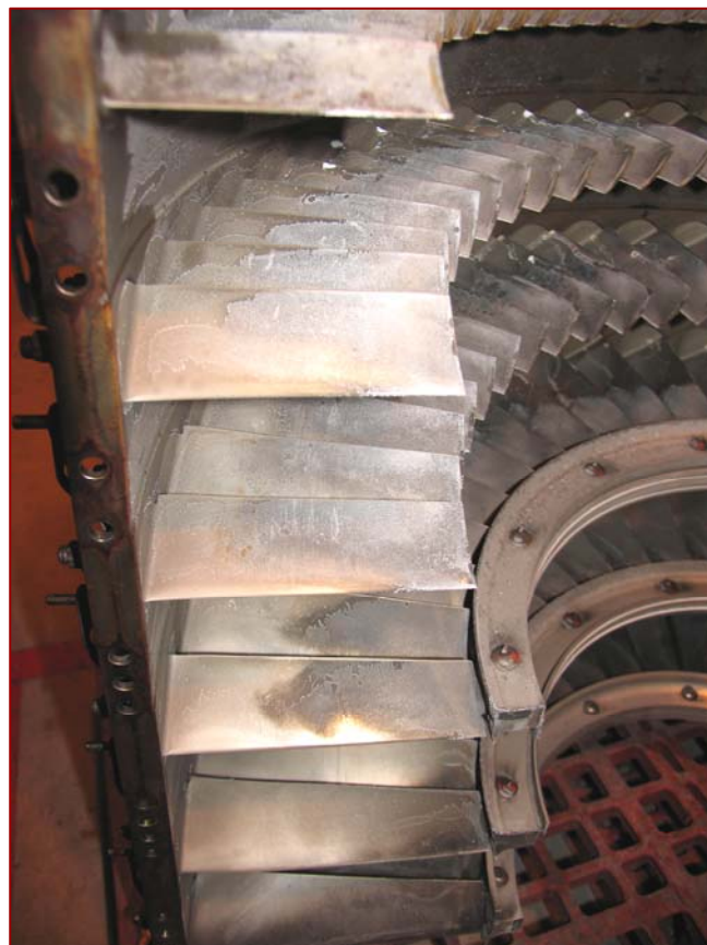
写真 2 9 粉末が付着したHPCベーン
