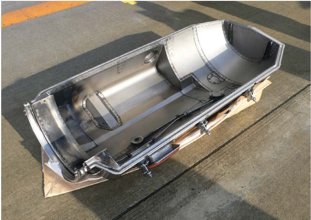
写真3 APU下側防火覆い
