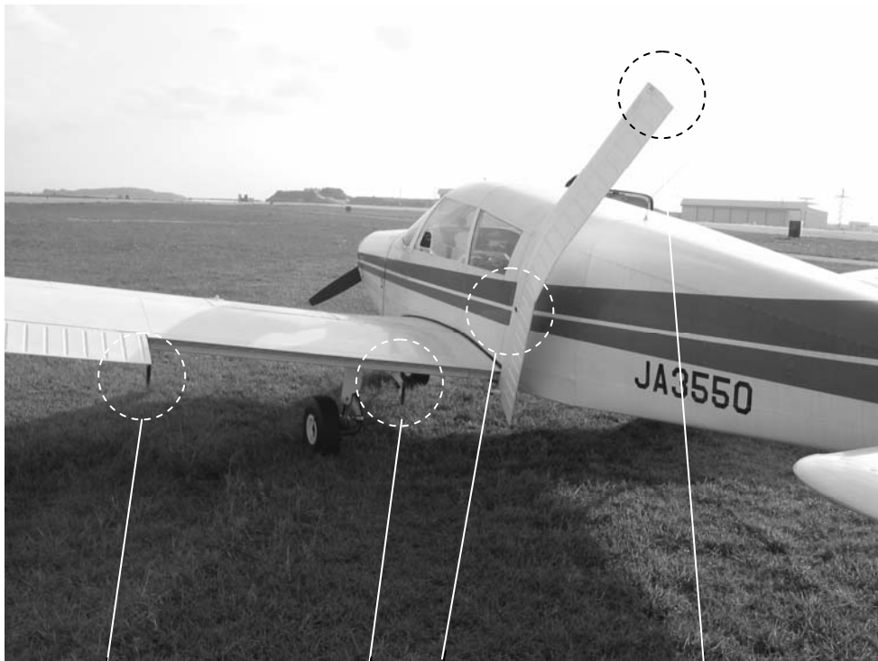
写真1 着陸直後の左フラップの状況
