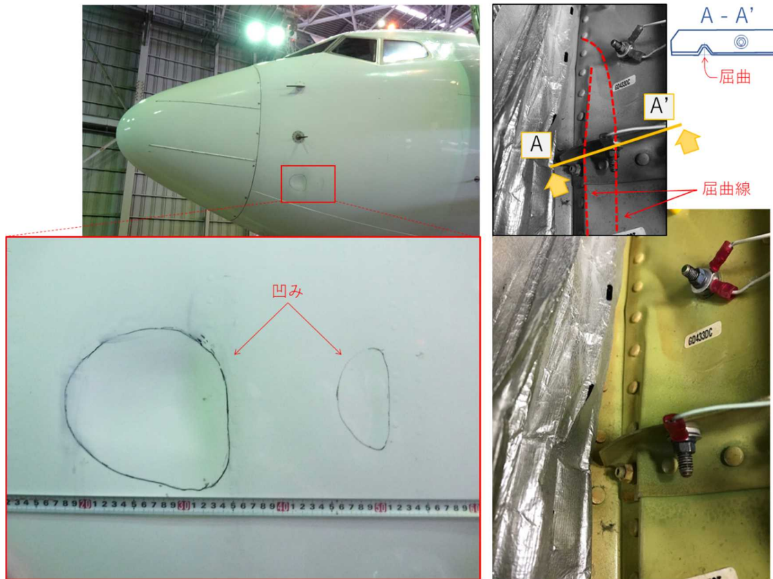
図2 機体損壊状況（左：胴体前方左側外板、右：内部フレーム）
