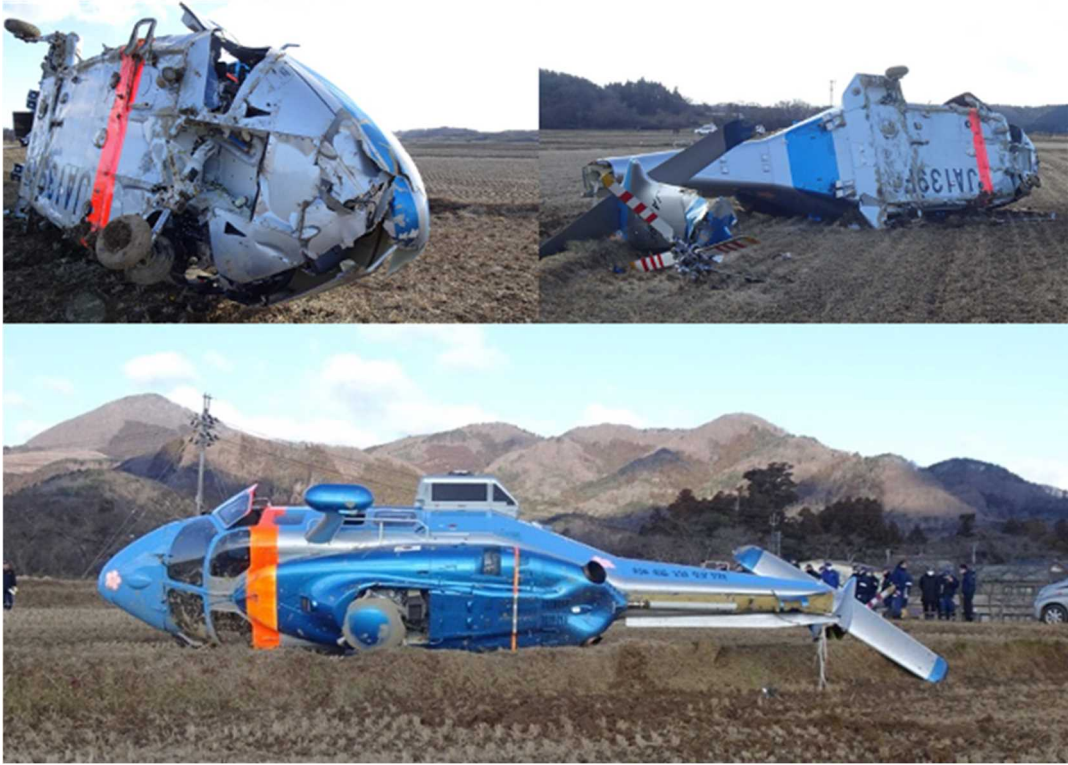
図 事故機の横転状況
