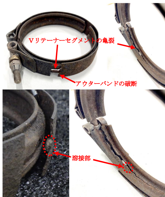
図5 カップリングの損傷
