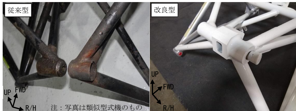
図9 アクチュエーター取付け部の形状比較
