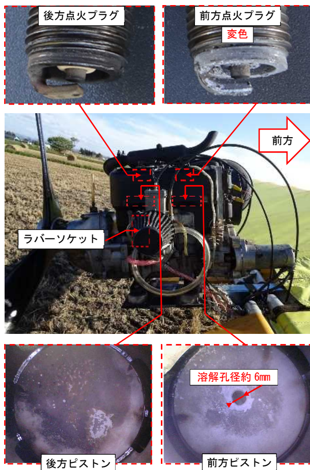
図3 同機エンジンの状況
