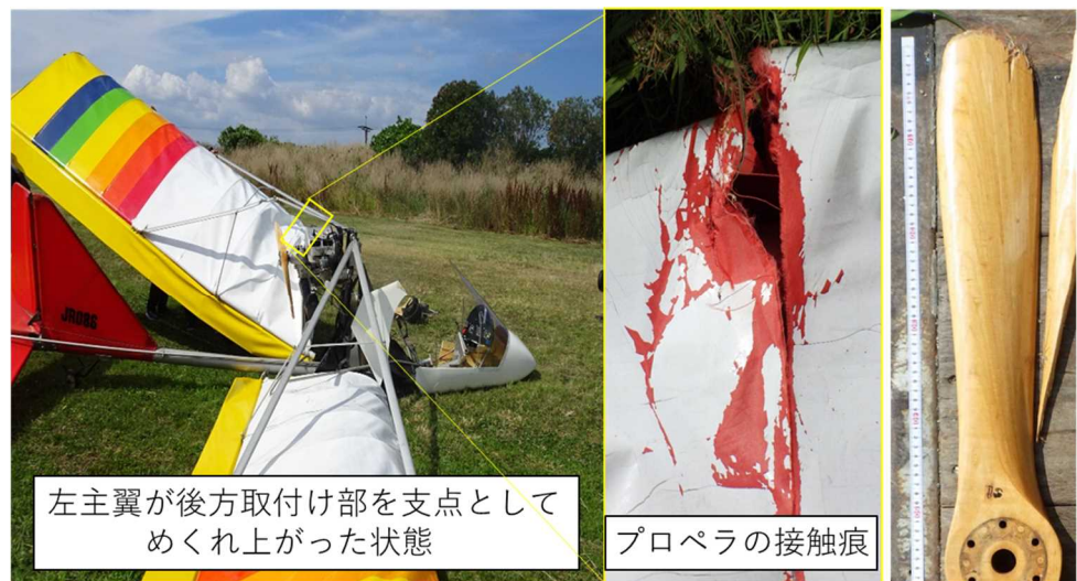
図13 損傷が少なかった側のプロペラ・ブレードと主翼の接触状況
