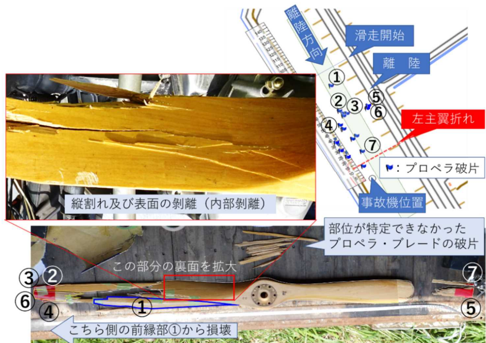
図1 2 プロペラの損壊状況
