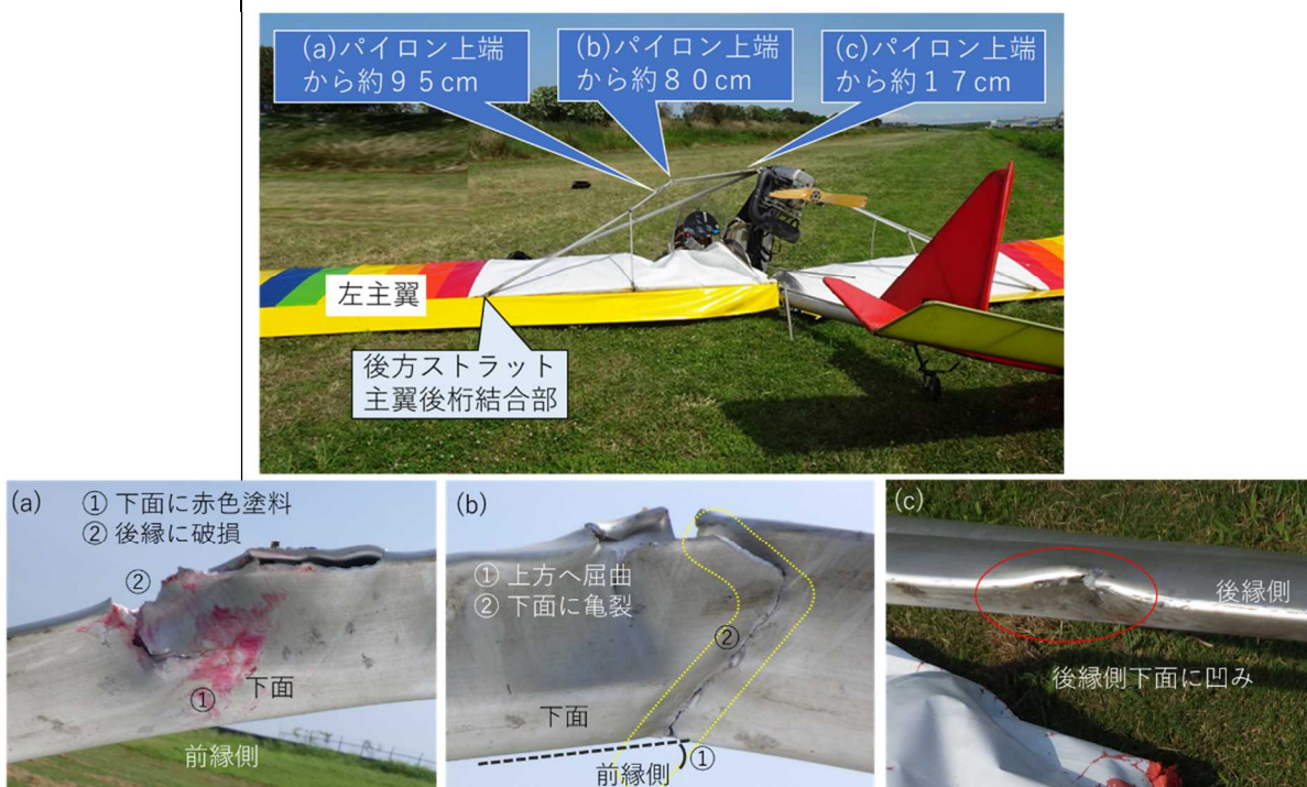
図8 ストラットの損傷状況
