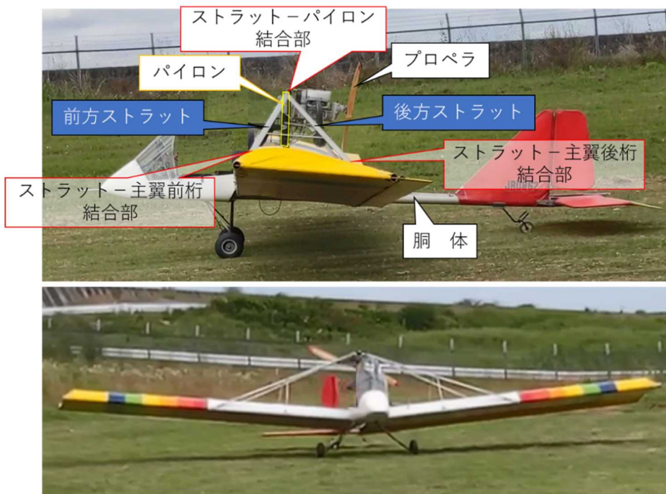
図7 ストラット（組立後の同機）
