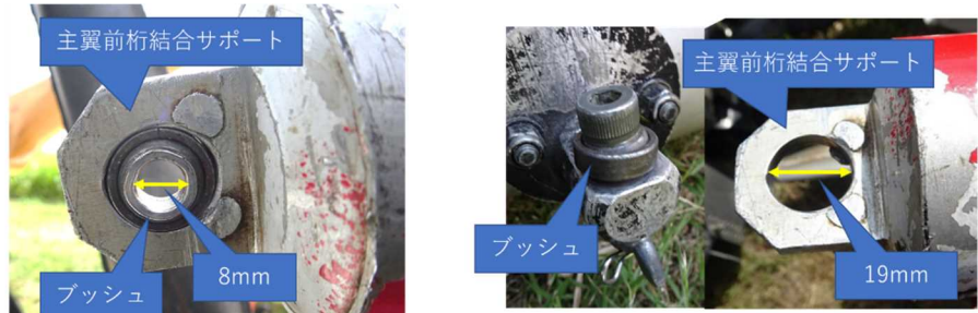
正しい状態：ブッシュが同サポートに圧入され固定
