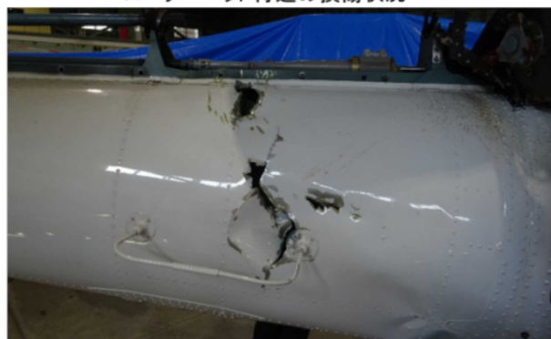
尾部右側面の損傷状況
