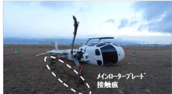
メインローターブレード接触痕
