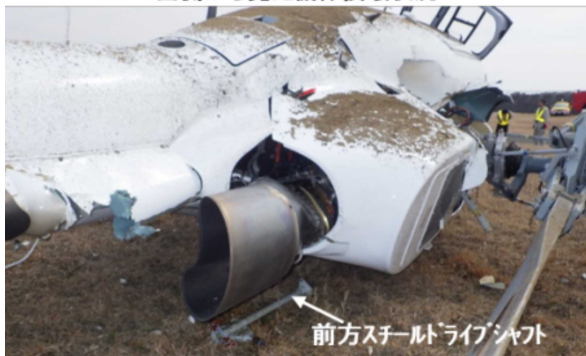
胴体上部破損状況
