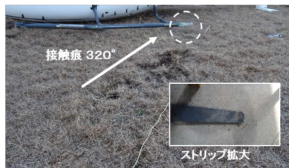
右スキッド後部ストリップ接触痕
