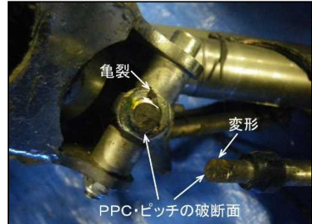
写真8 PPC・ピッチの破断面
