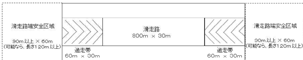
図2. 18. 6-1 同飛行場の滑走路、過走帯及び必要とされる滑走路端安全区域
