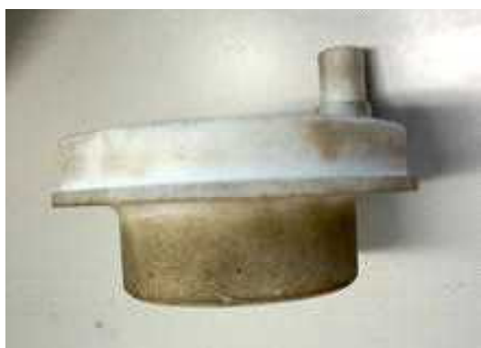
写真# 24 3Dプリンタで 製作したプロペラブレード根本部分
