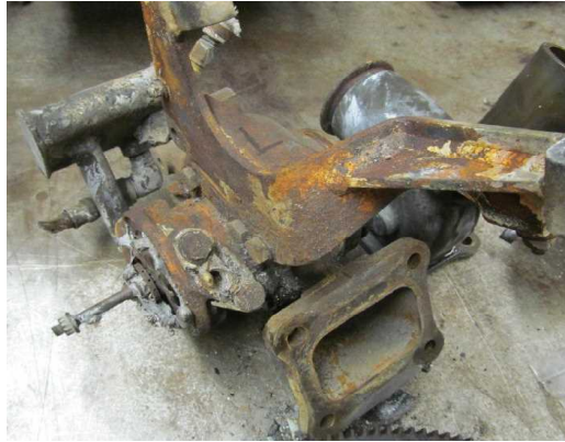
写真# 1 8 左側ターボチャージャー部の状況
