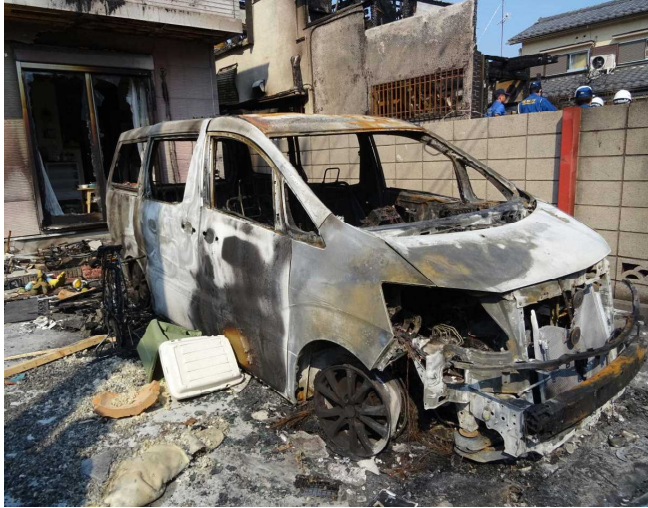
写真2.4.2-5 住宅Cの自動車の焼損状況
