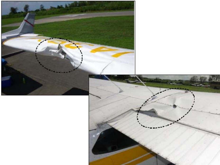
写真3 右主翼の損壊状況
