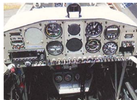
(写真A 後部操縦席計器盤)
