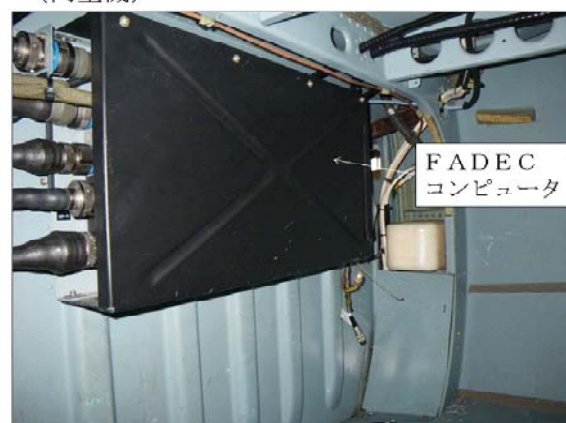
FADEC コンピュータの取付状況（同型機）
