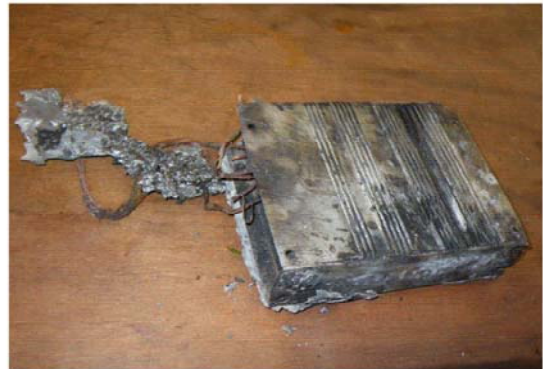
NTSBが調査したストロボライト・パワーサプライ及び配線
