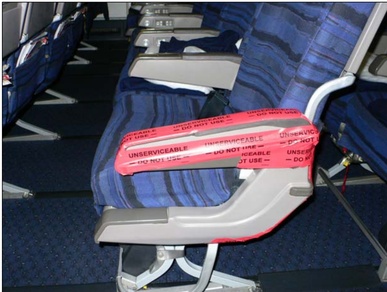
アームレスト の損傷
