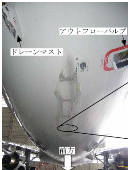
写真2 胴体の損傷状況
