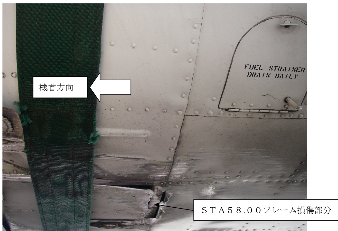
写真3 フレーム損傷状況
