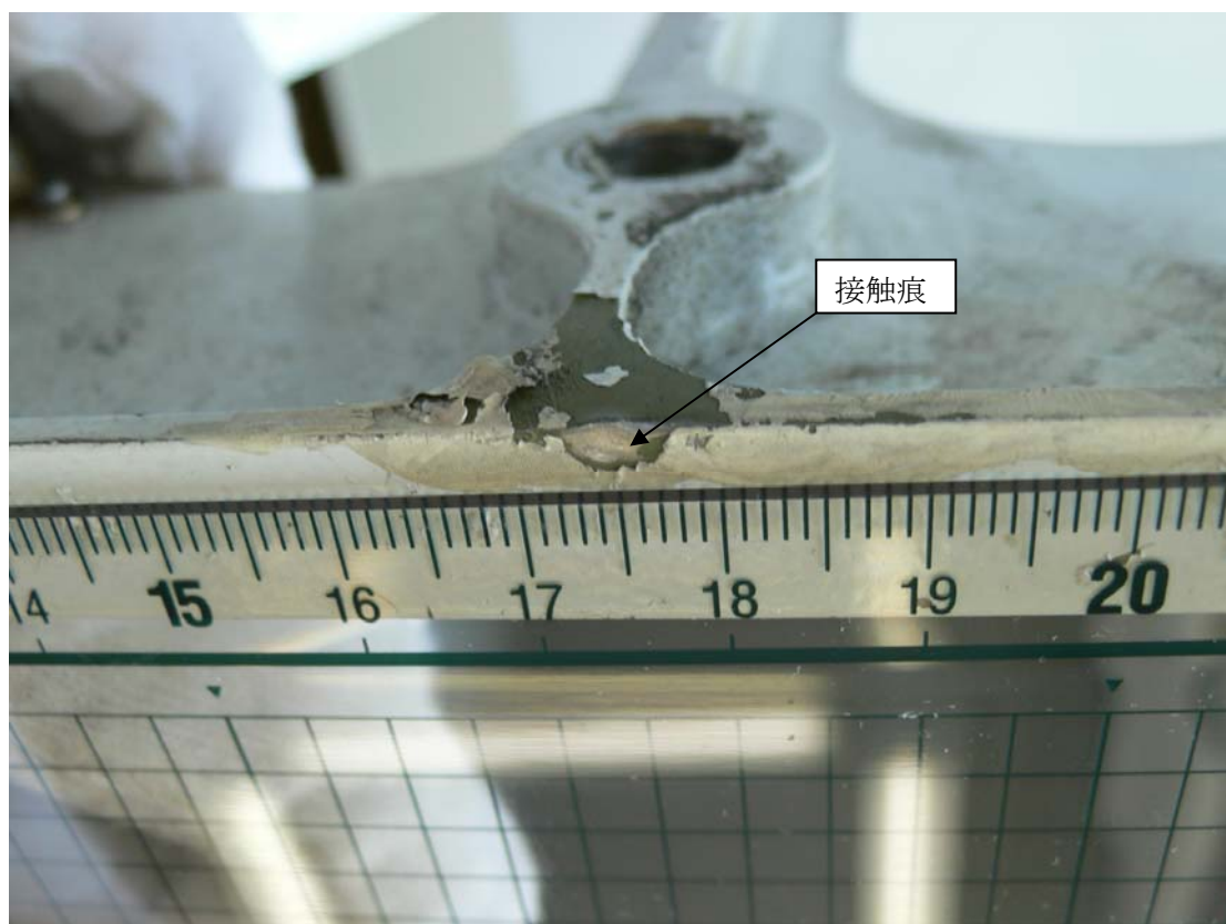
写真15 サポート・フィッティング塗装剥がれ
