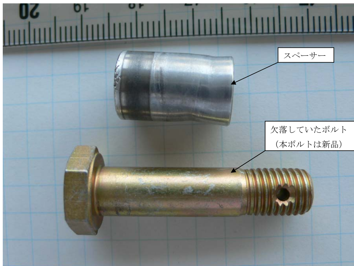
写真5 同機のスぺーサー及びボルト
