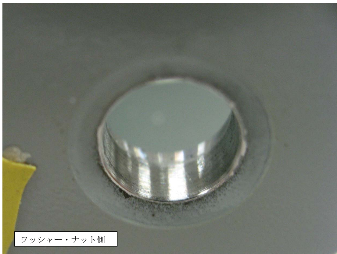
写真14 新品のフランジ・ブッシングの内面
