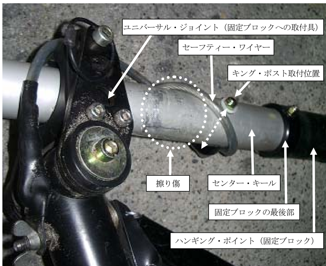
写真3 グライダー部とトライク部の取付状況
