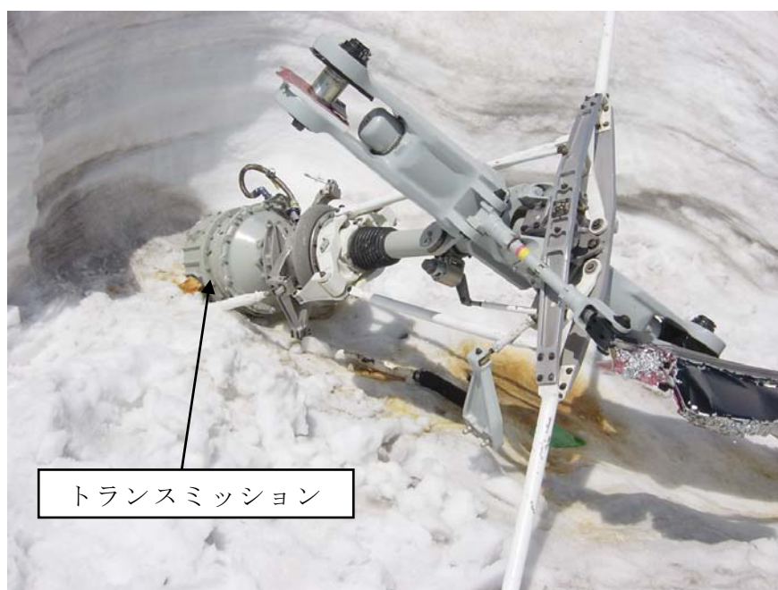
写真4 脱落したマスト部 (除雪後)
