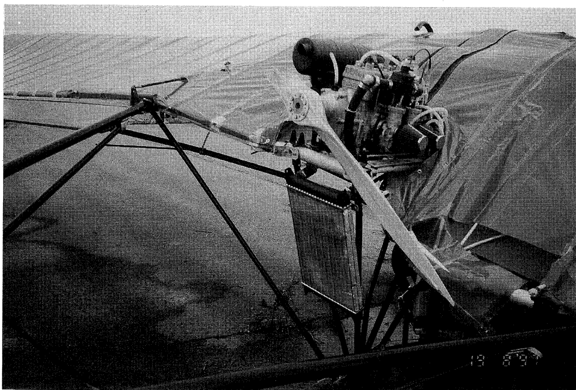
写真6 プロペラ・ブレードの損傷状況
