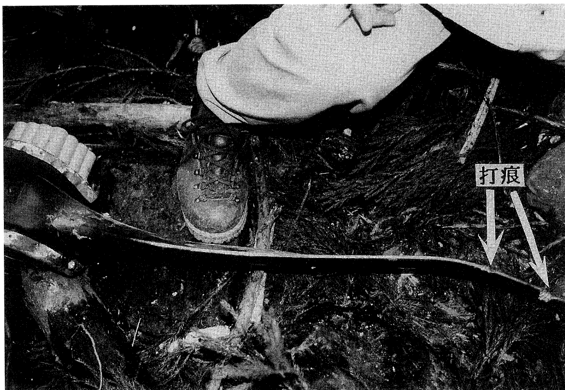
写真5 プロペラ・ブレード前縁の打痕
