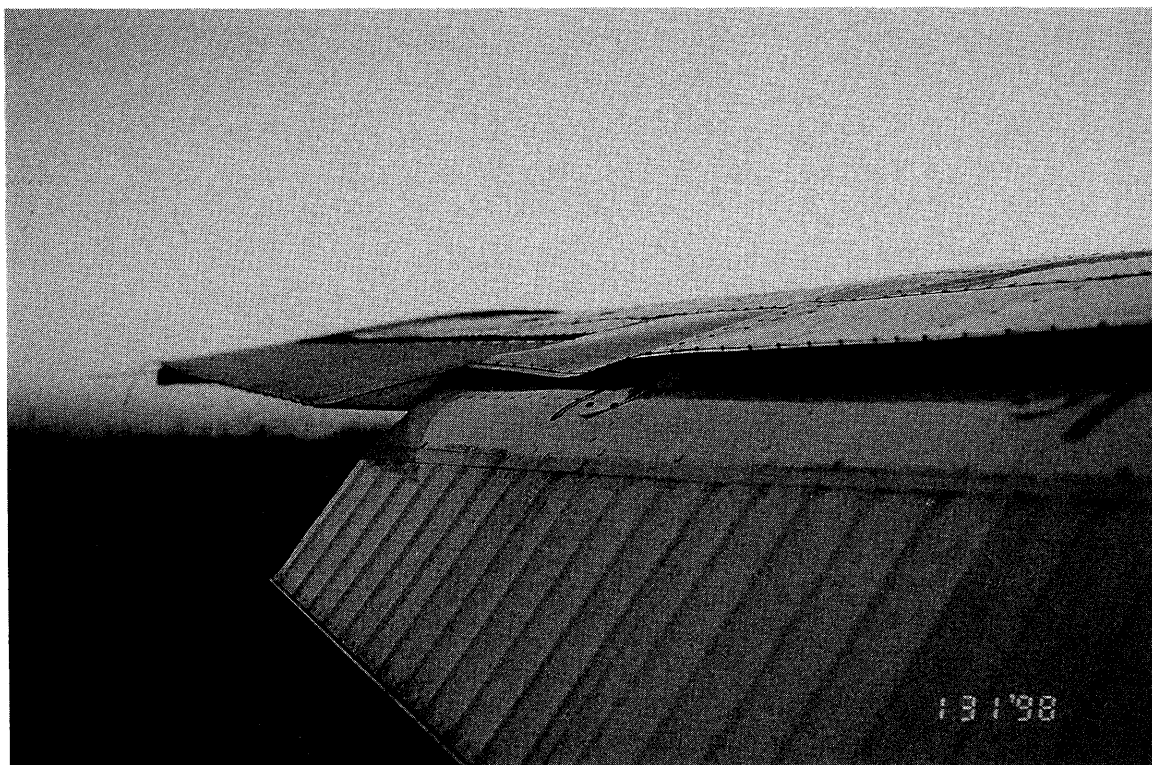
写真3 左翼上面外板後縁部の凹凸
