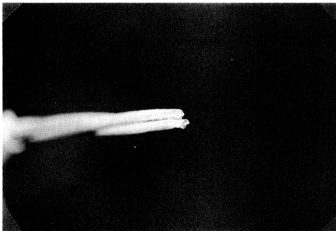
写真5 切断された支索(道路側)
