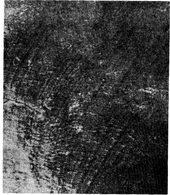
写真4 ブレード破断面の電子顕微鏡写真(×500)
