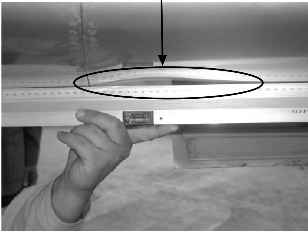
写真2 左主翼下面損傷部（前方から桁の直前部を見る） リブ間の外板の凹み（最大深さ約5 mm）
