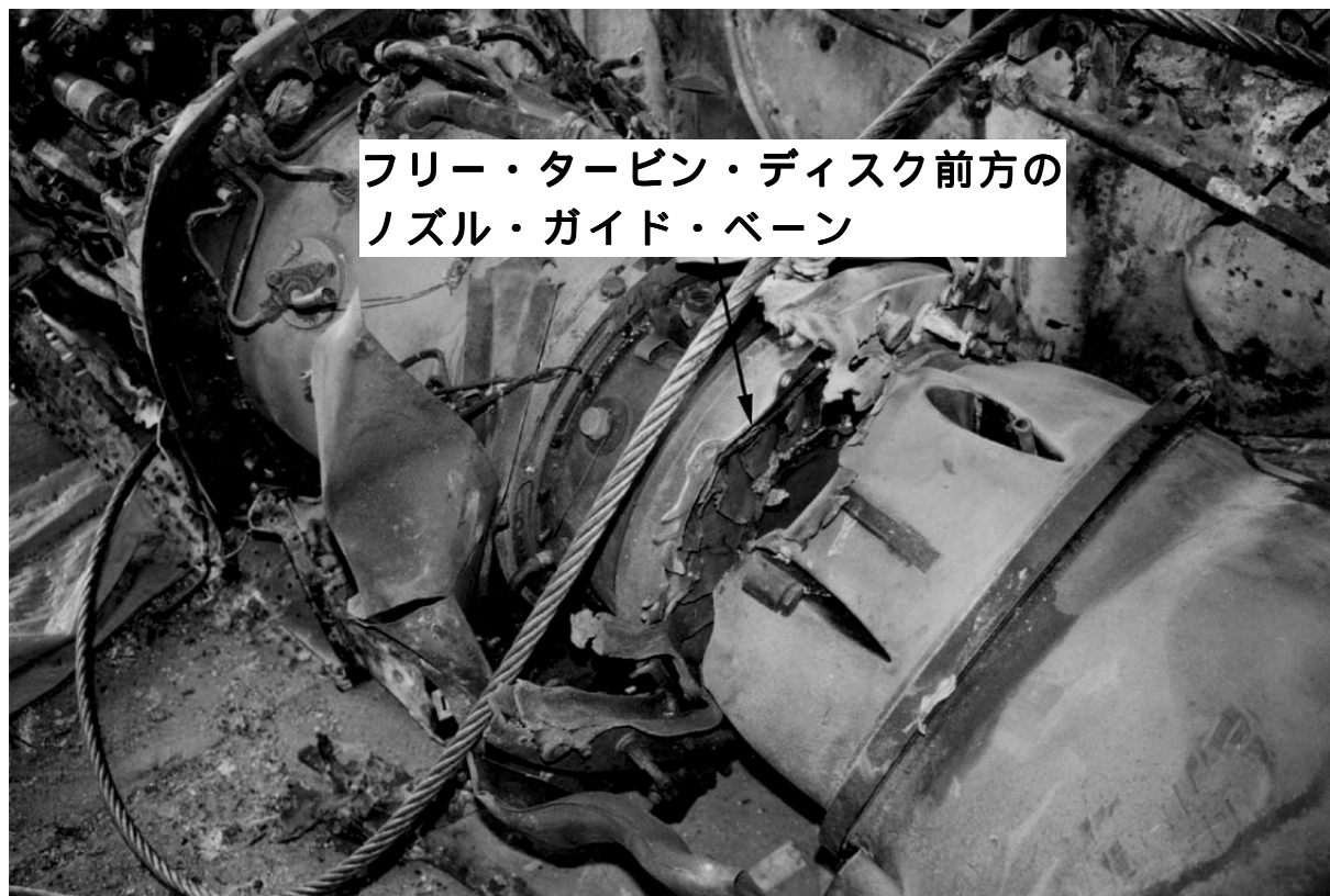
別添写真2 No.1エンジンの損傷状況 - 2
