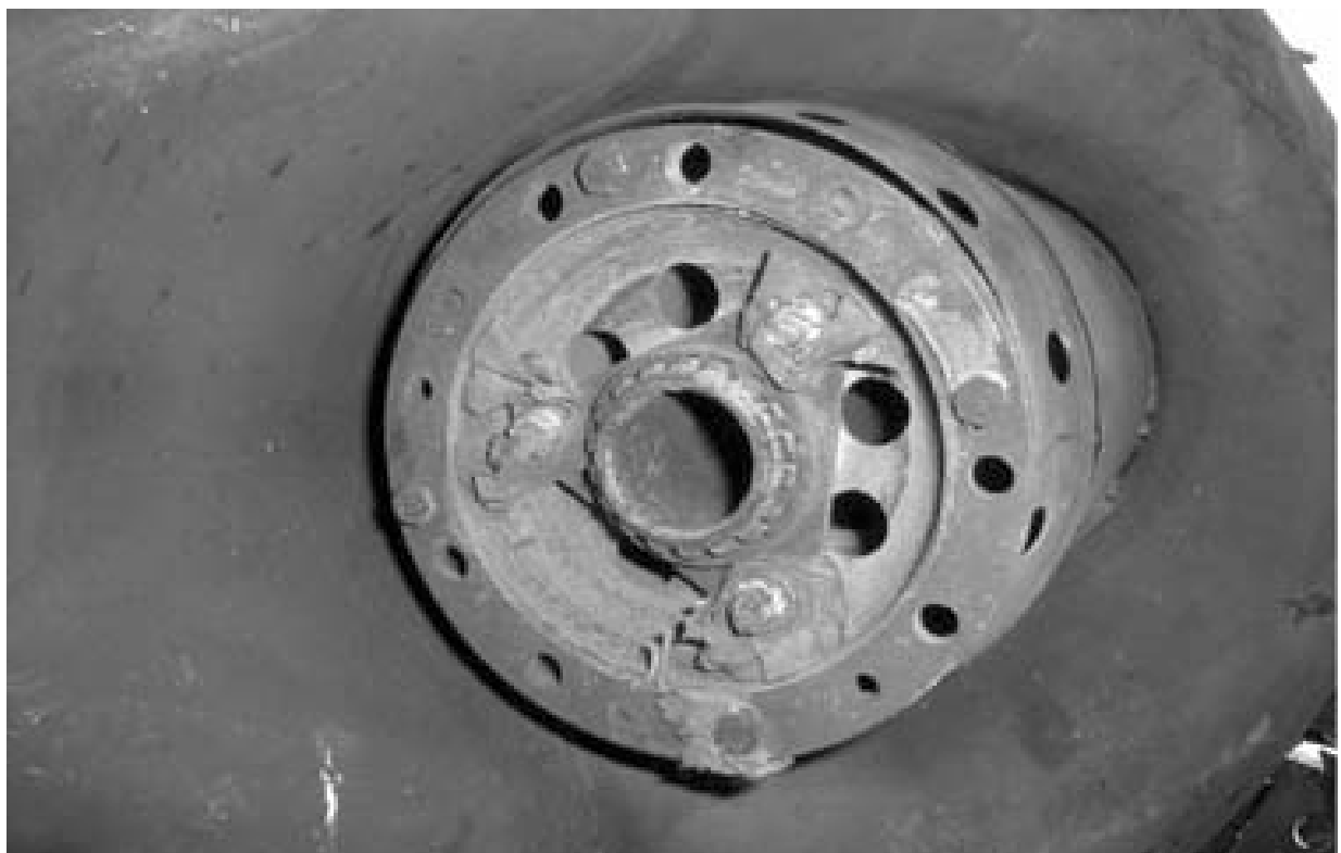
写真8 No.1エンジンの損傷状況 MGBパワー・インプット部 (MGBインプット・フレクタ)
