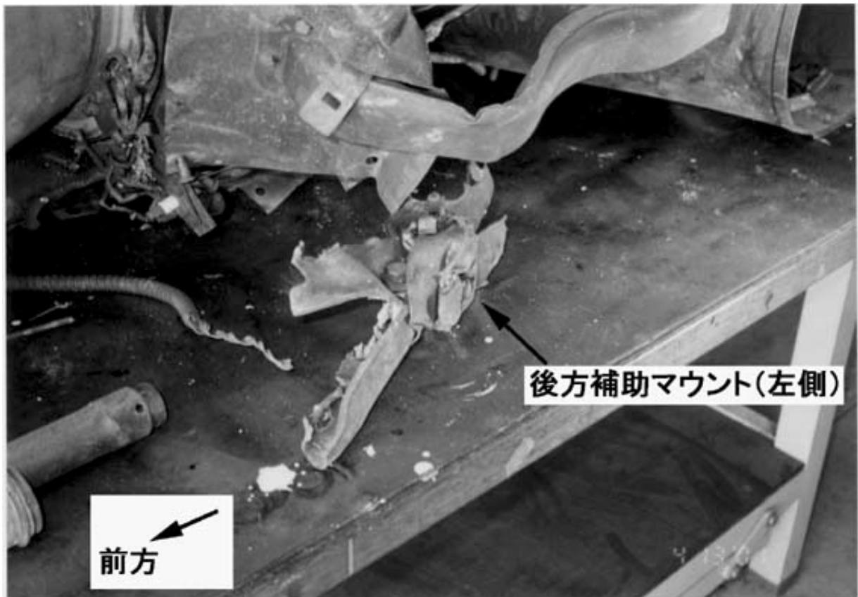
別添写真5 No.1エンジンの損傷状況 - 5
