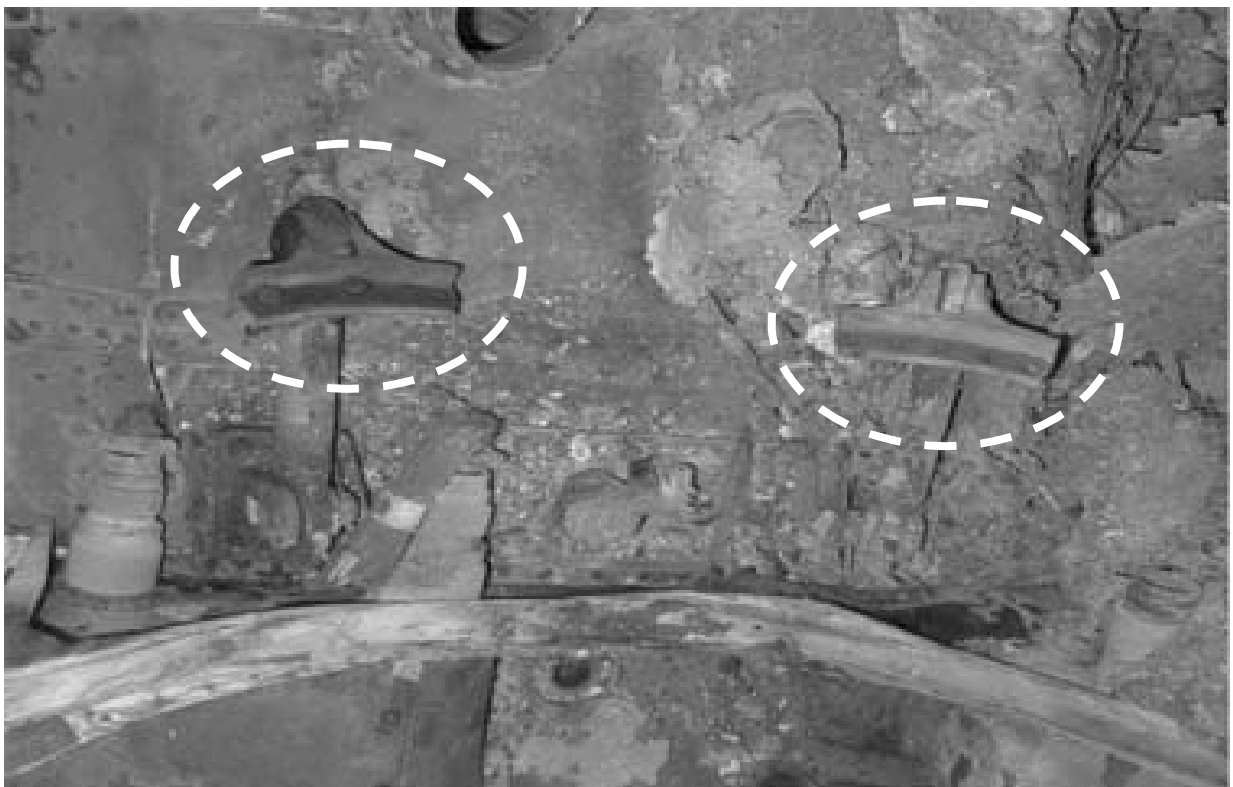
別添写真4 No.1エンジンの損傷状況 - 4 前方マウントのエンジン取付部
