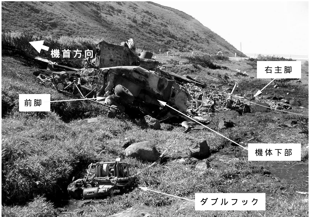
写真3 事故機（機体下部前方側）
