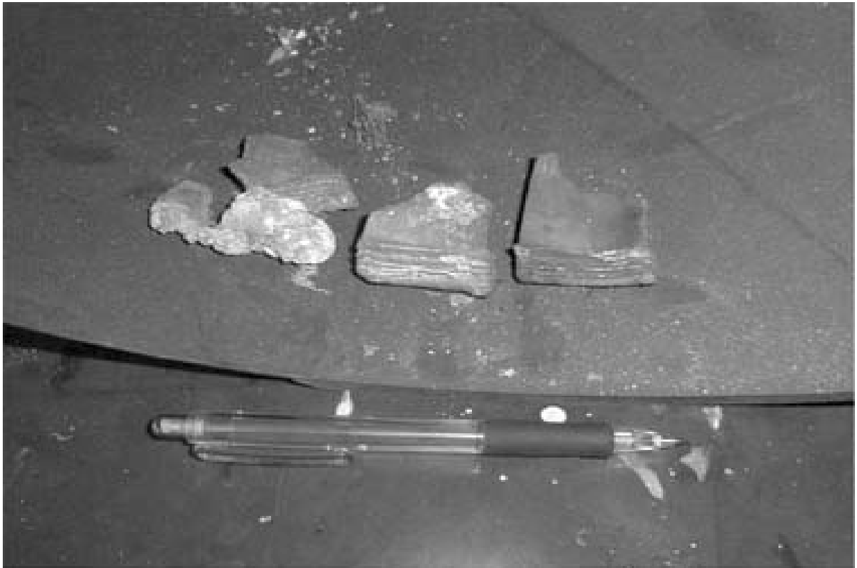
別添写真3 No.1エンジンの損傷状況 - 3 フリー・タービン・ブレード埋め込み部の破断面
