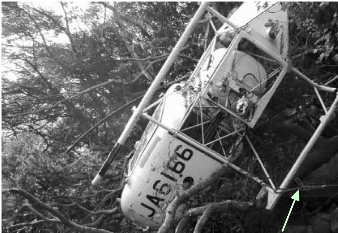
事故後に設けた機体固定用ロープ
