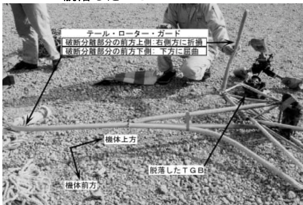
写真3 損傷したテール・ローター・ガードと 脱落したTGB
