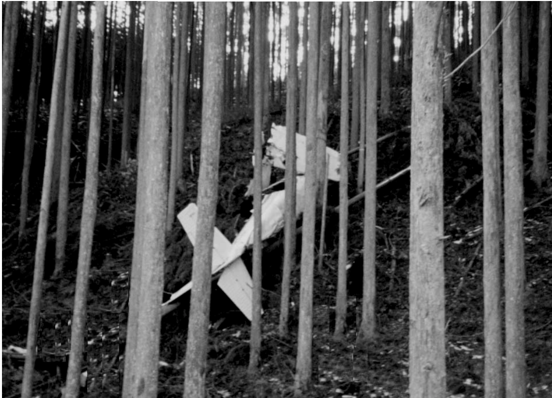
写真2 事故機破断状況
