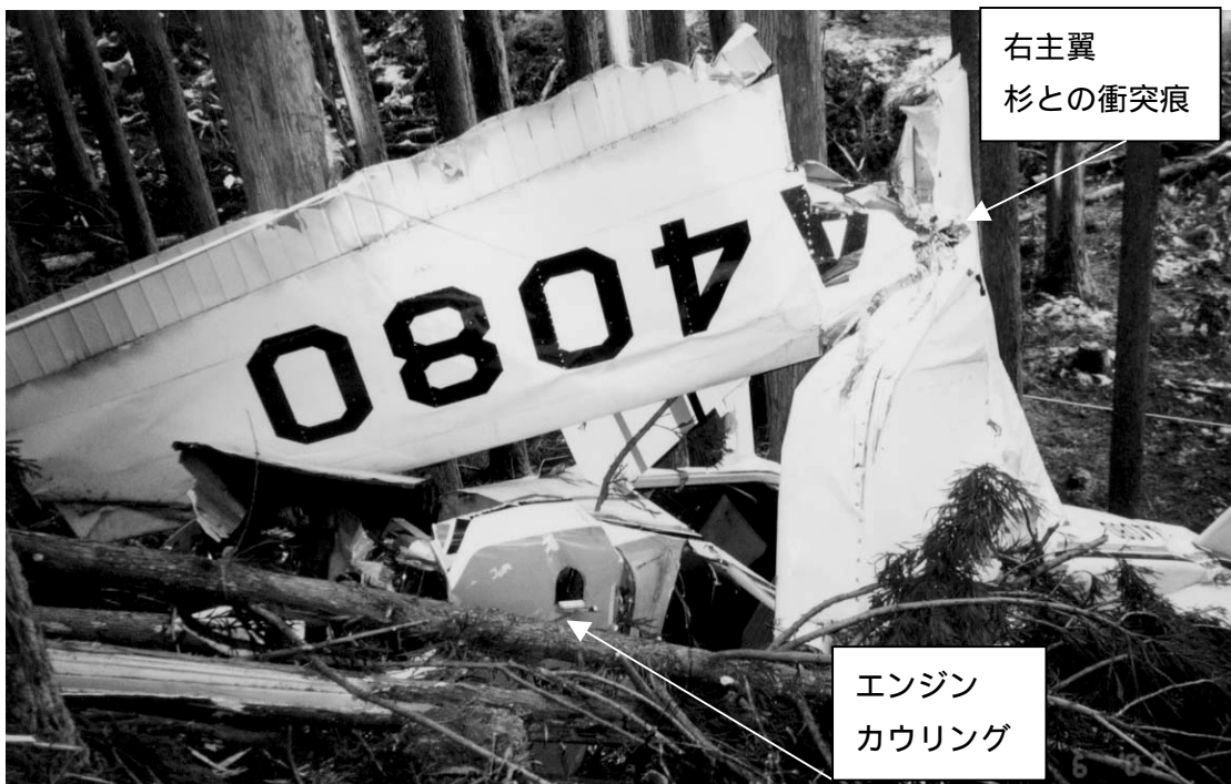
写真2 事故機破断状況
