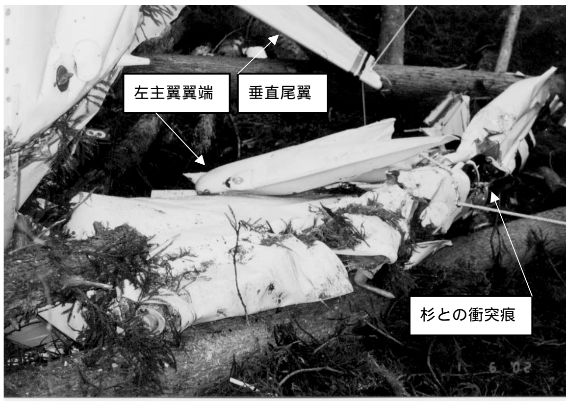
写真4 左主翼破断状況
