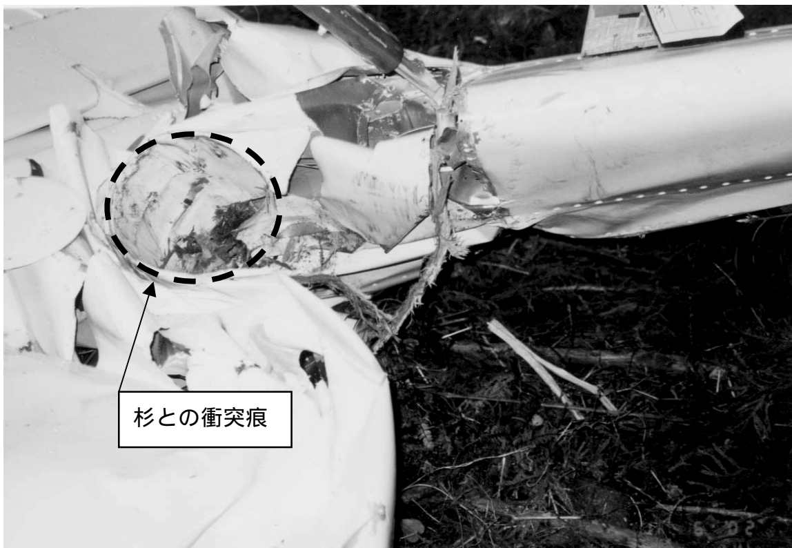
写真4 左主翼破断状況
