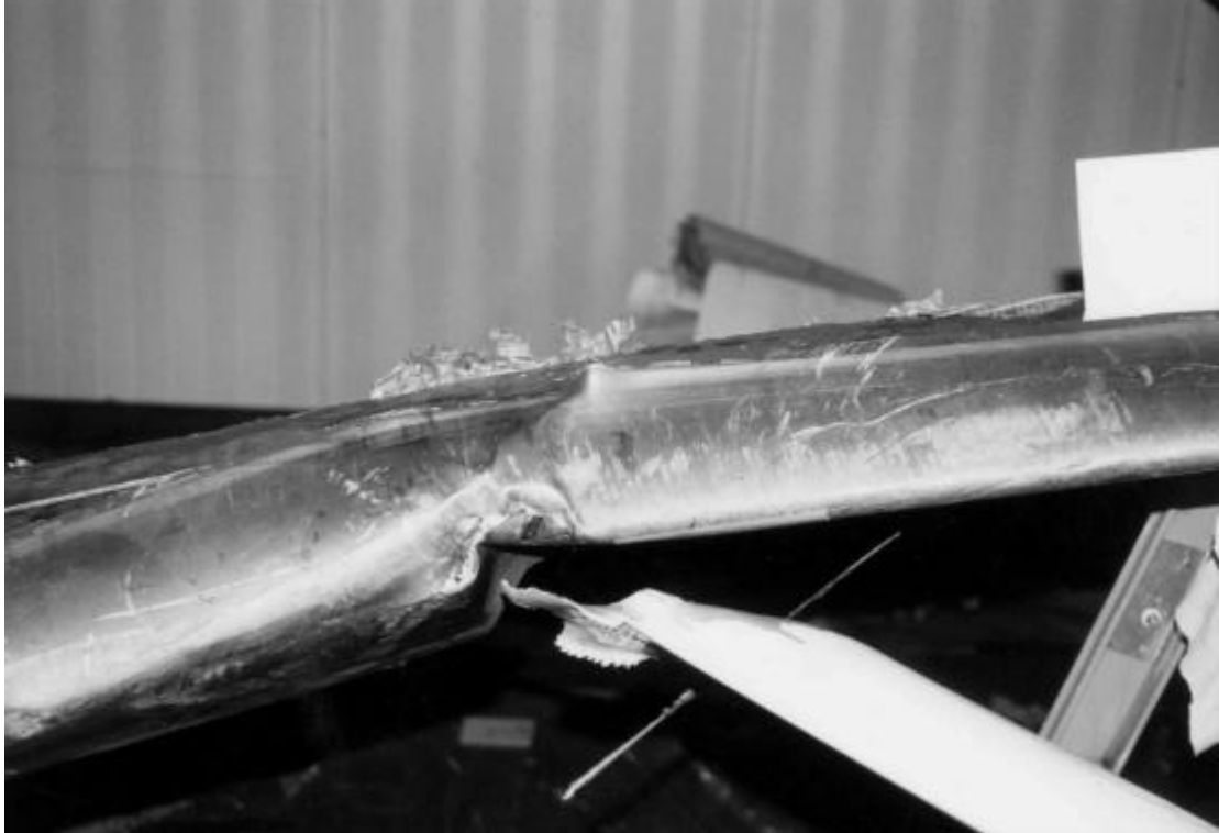
写真8 A機の黄MRB （左フラップのベル・クランクのボルト及びナットとの衝突痕）
