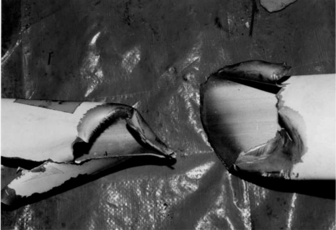
別添写真3 B機の右主翼ストラットの破断部
