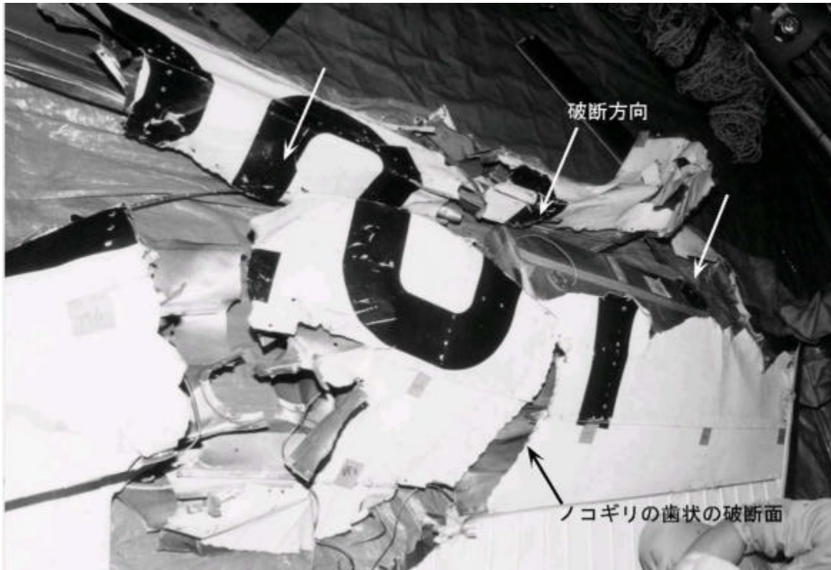
写真 1 5 B 機の右主翼前桁の破断部
