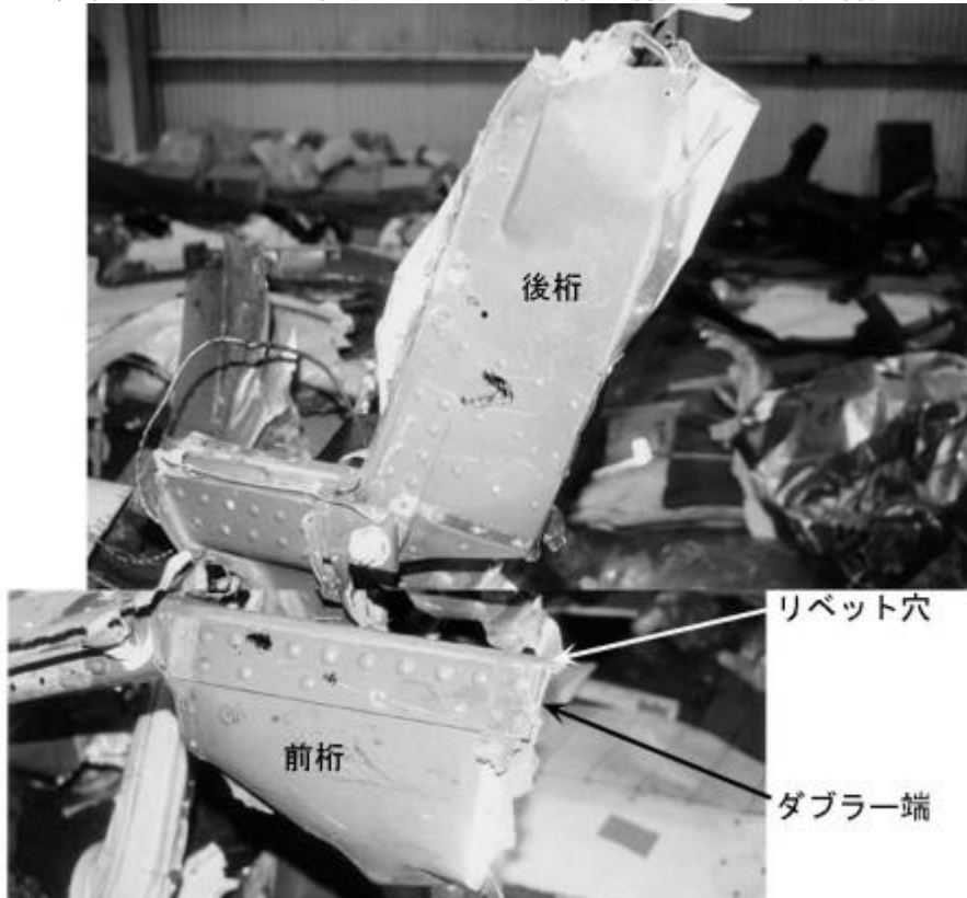
写真 1 3 B機の左主翼前桁及び後桁の破断部
