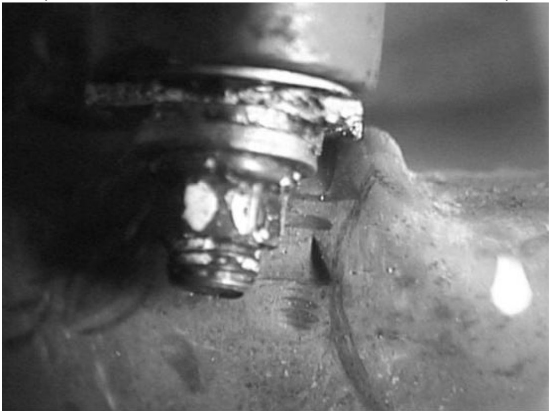
写真8 A機の黄MRB （左フラップのベル・クランクのボルト及びナットとの衝突痕）
