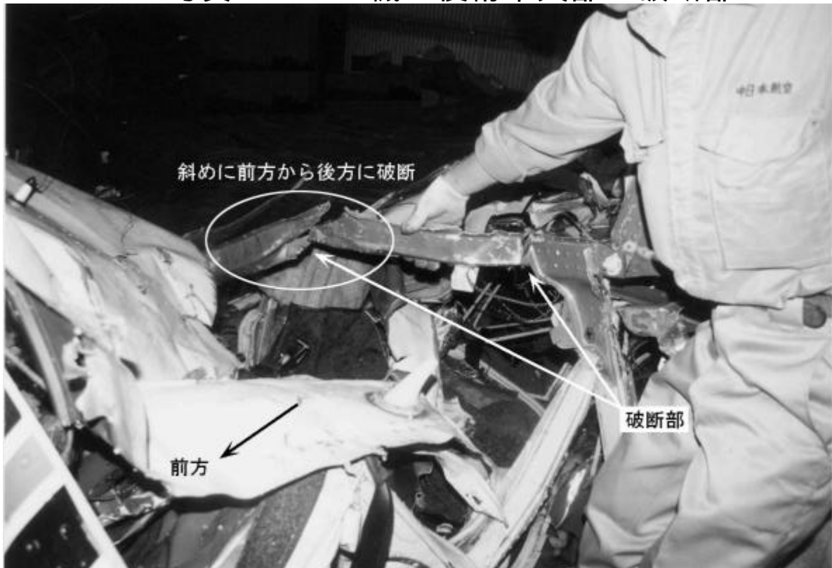
写真 1 7 B 機の後桁中央部の破断部
