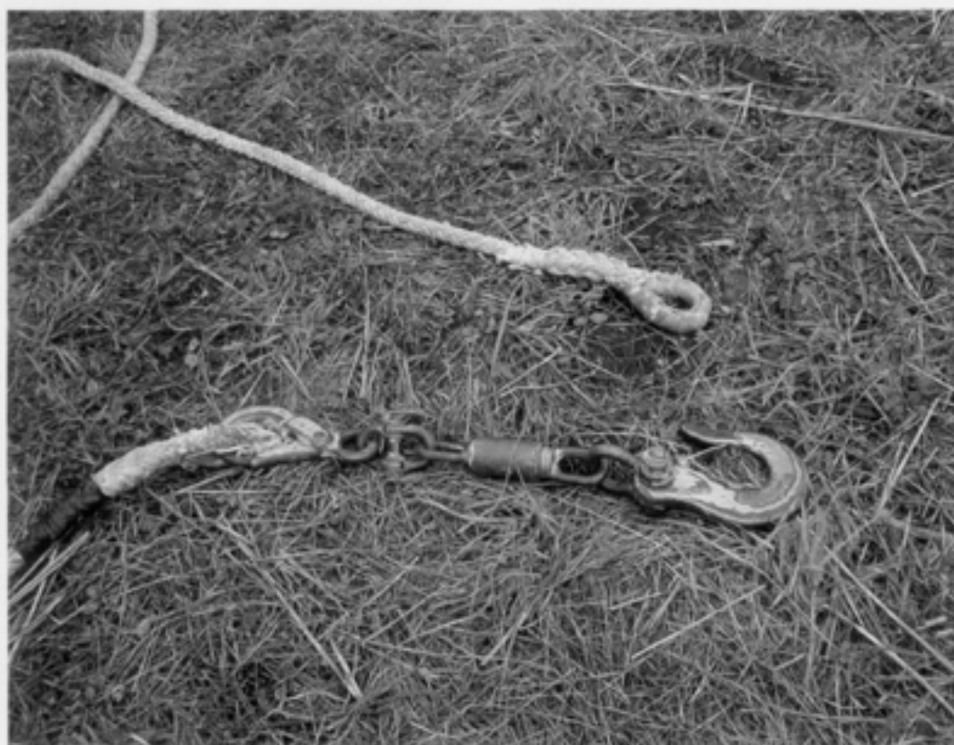
写真3 スリングのフック
