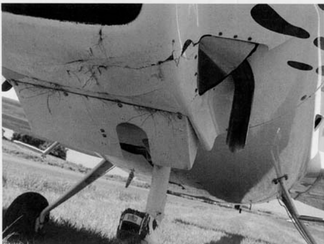
写真2 胴体下面の損傷
