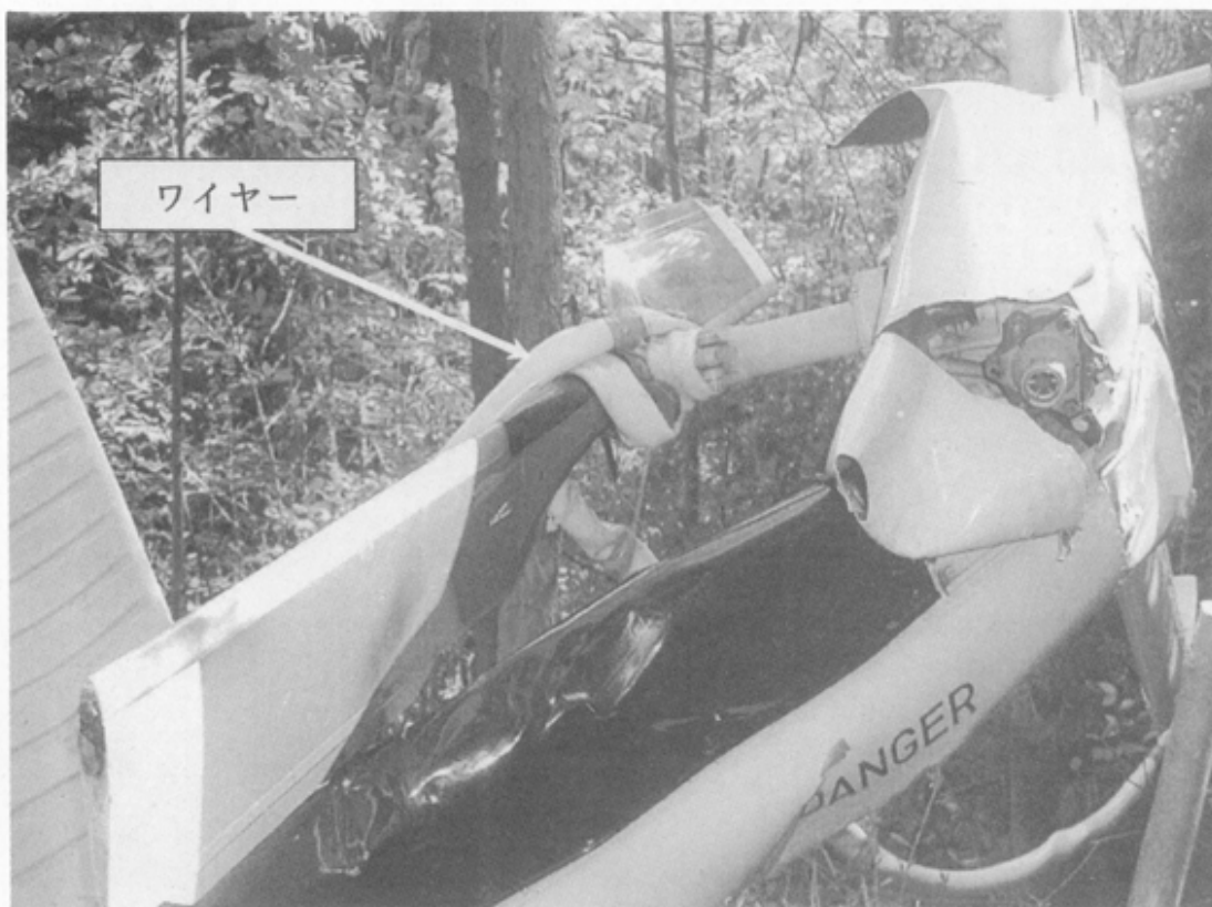
写真2 テール部損傷状況
