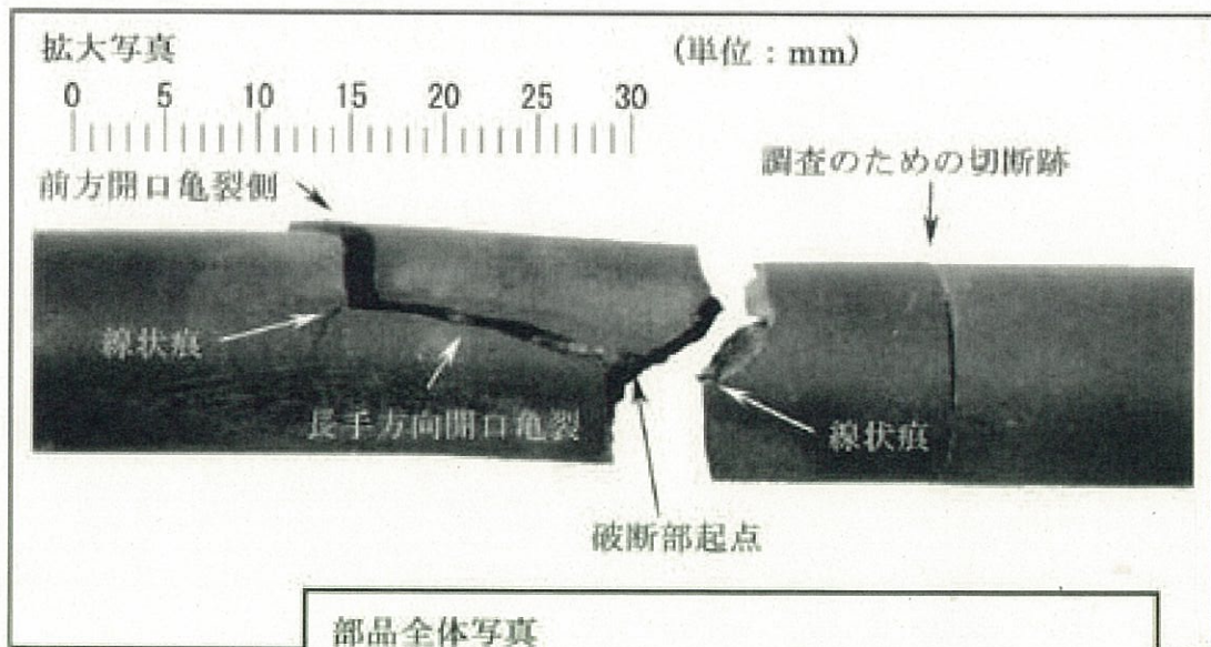
破断したパワーシャフト・ボルト
